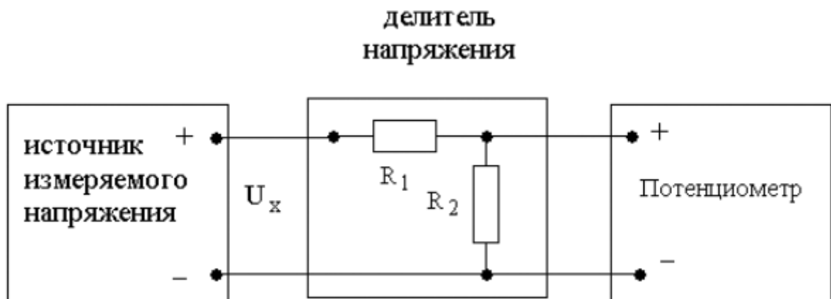
Рис. 3.3.2 Схема подключения потенциометра для расширения пределов измерения
